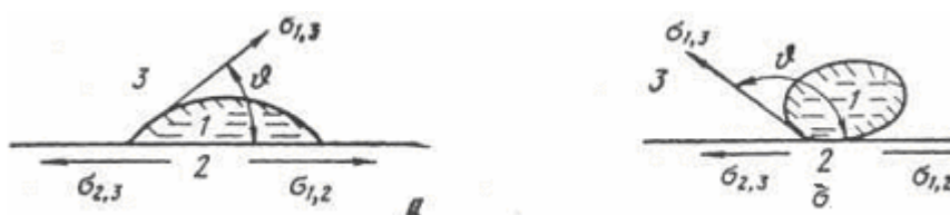
Рис. 2.3 - Распределение сил поверхностного натяжения на гидрофильной (а) и гидрофобной (б) поверхностях твердого материала:
